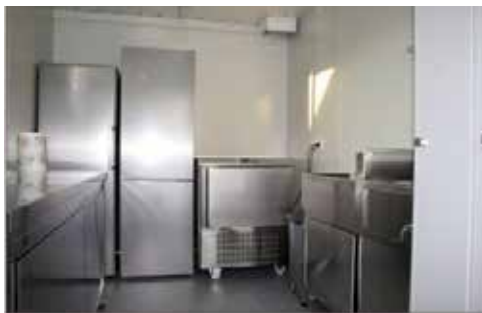
Slika 6. Primjer mobilne preradbene jedinice sa svom potrebnom opremom za primarnu obradu i pakiranje mlijeka
